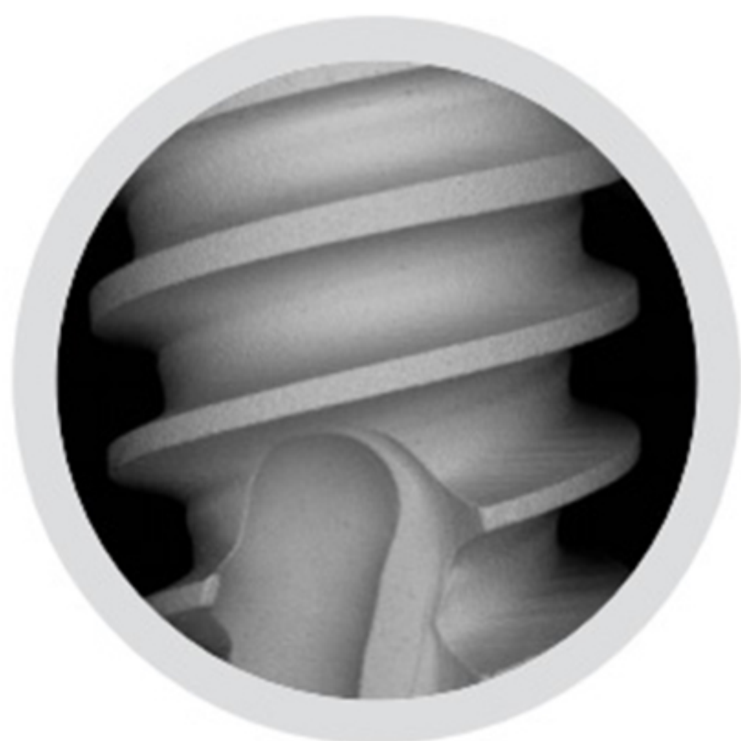
Зображення, отримане методом скануючої електронної мікроскопії (СЕМ), 25-кратне збільшення: чиста однорідна поверхня без забруднення
