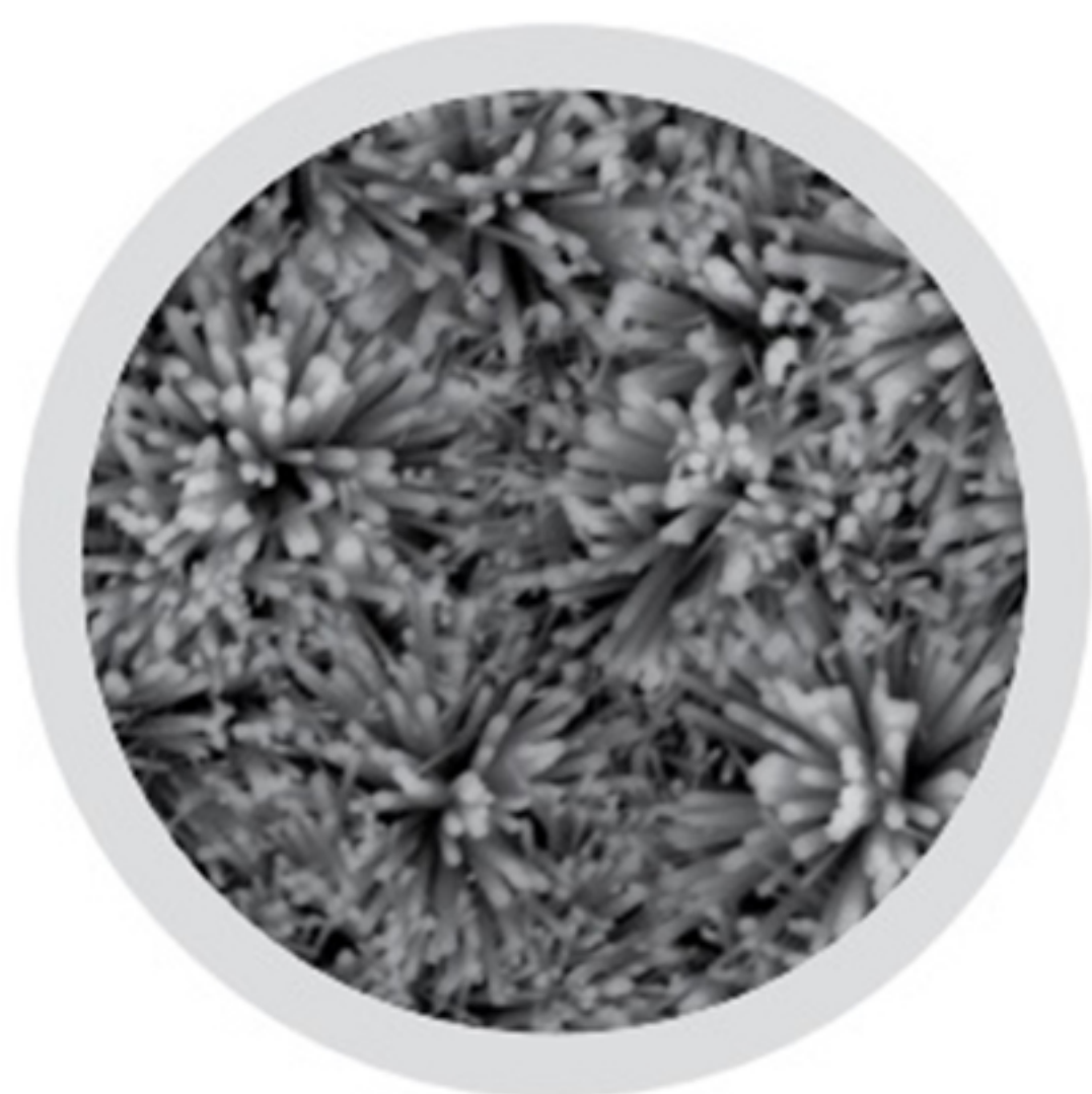
Зображення, отримане методом СЕМ, 2000-кратне збільшення: чиста однорідна кристалічна структура покриття SBTC
