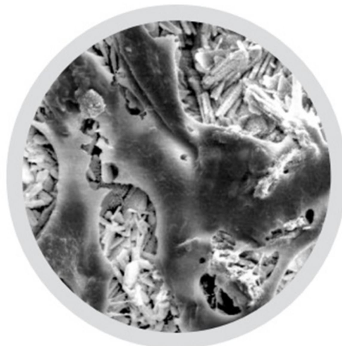
Остеобласти людини на поверхні покриття SBTC
